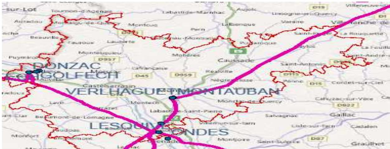
En violet : tronçons de réseau RTE équipés en fibre optique ouverts à la location
