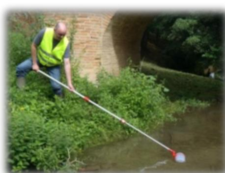
Prélèvement d'eau à l'aide d'une canne de prélèvement
