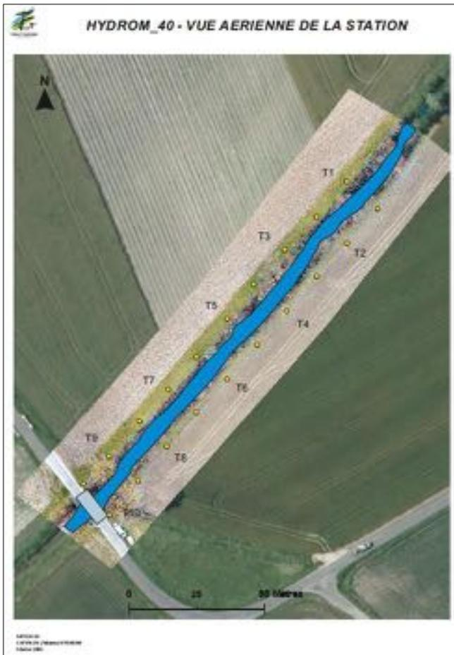
La phase de saisie réalisée, le lit mouillé de la station est tracé aussi précisément que possible sur le SIG de la CATER-ZH82. On utilise pour cela le relevé orthophotogrammétrique réalisé grâce au drone. On précise également le tracé en reportant les côtes mesurées in situ (*distance mesurée entre la limite du transect et la berge mouillée du lit*).
